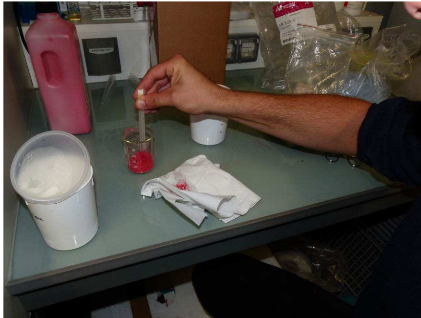
Figure 11 : Mise en place de la poudre de rebouchage (© Ph Jatteau, Inrae)
