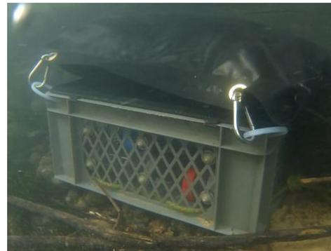
Figure 7 : Système d'immersion contenant les cages de gammarès
