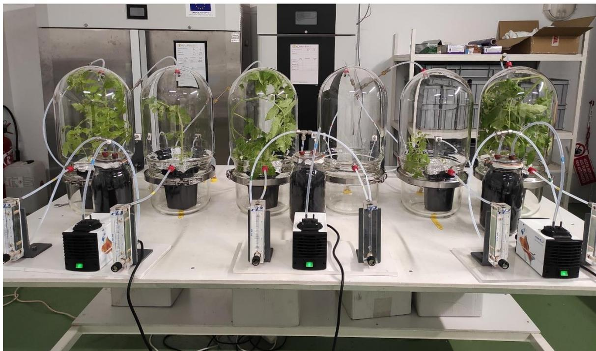
**Figure 17.** Dispositif d'échantillonnage des COVs émis
