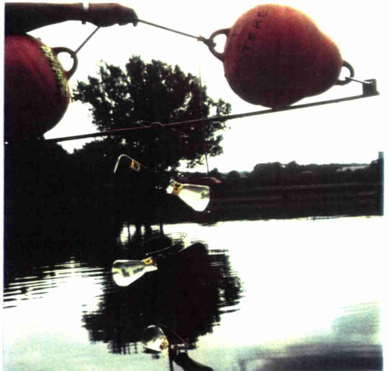
Dispositif utilisé pour l'incubation au C14 radioactif
