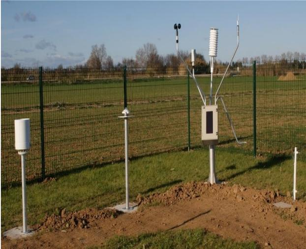
**Figure 6 : Photo de la station météorologie CLIMATIK du réseau INRAE à Mauguio.** Les données recueillies sont la température (degrés Celsius (°C)), l'hydrométrie ou humidité de l'air (humidité relative (hr)), le vent (force (km/h) et direction (points cardinaux)), le rayonnement solaire (joules/cm<sup>2</sup>) et la pluviométrie (mm).
