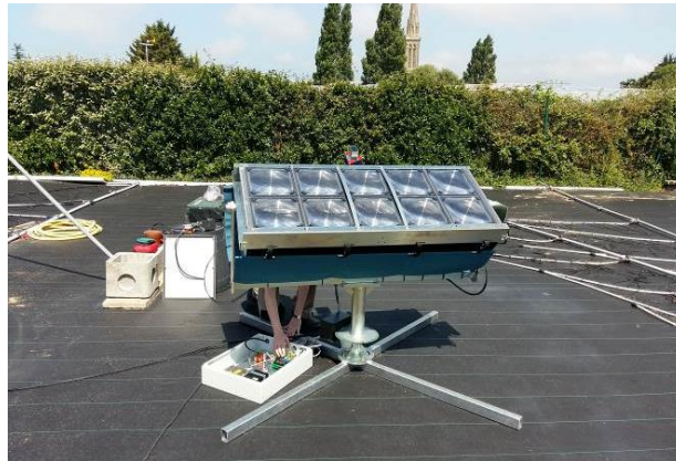
Figure 3 : Capteur solaire avec 10 lentilles de Fresnel développé par la société Echy. (©ASTREDHOR)
