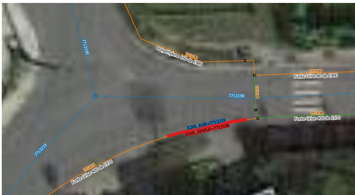
Figure 26 : Exemple de conduite agrégée qui change d'ICAR de rue du fait de son agrégation.
