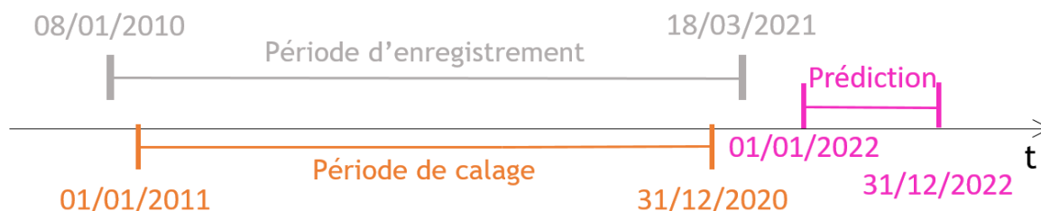
Figure 3 : Représentation des périodes de calage et de prédiction pour un objectif de prédiction des défaillances. Lors de la prédiction, le modèle est recalé en utilisant toutes les données disponibles, c'est-à-dire la réunion des périodes de calage et de validation utilisées précédemment.
