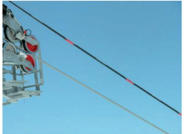
**Figure 32** : Systèmes de signalisation des câbles pour l'avifaune
