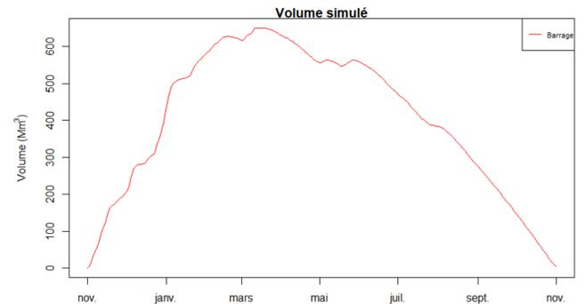
Exemple de simulation « supervisée » de chroniques de débits et de volume d'un réservoir situé à l'amont contraint par un débit réservé et supportant l'étiage à l'aval
