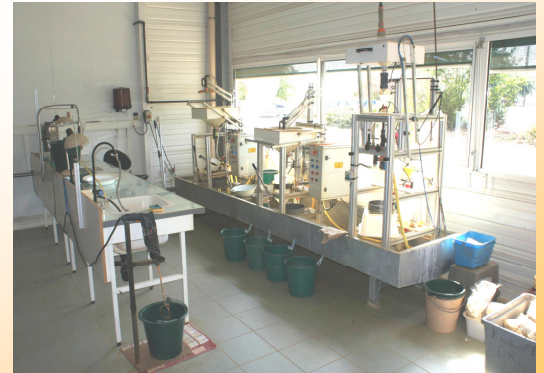
Poste de travail pour l'extraction des racines et des graines du sol avec Racinator I & II.
