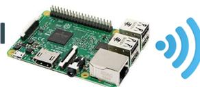
Interface entre le Wifi local (IP = 192.168.0.254) et le réseau Ethernet INRAE (IP = 147.100.x.x)
