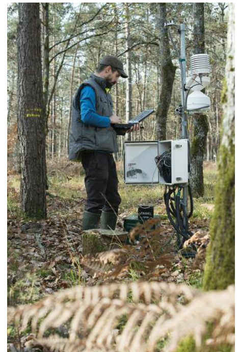
1 - Relevé d'une centrale d'enregistrement des données des appareils de mesure du microclimat (capteurs de température, humidité relative de l'air, rayonnement, pluviomètres, sondes d'humidité du sol, piézomètres).
