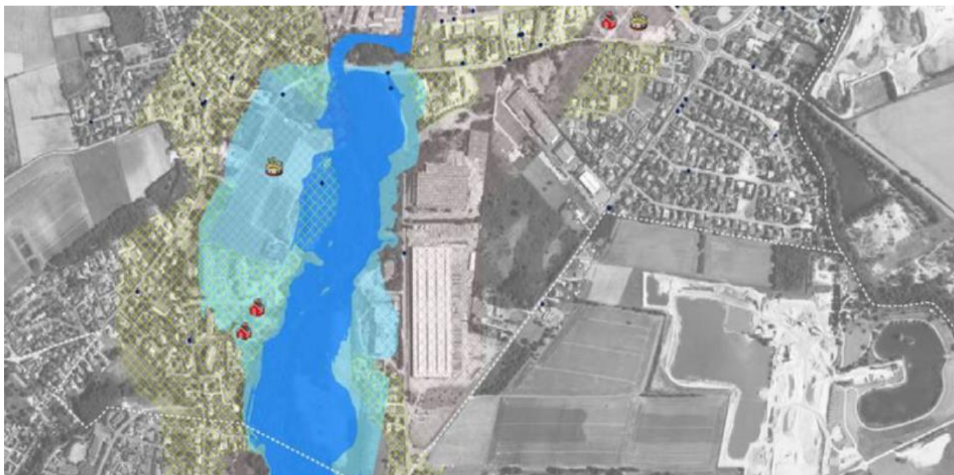
Figure 3 : Exemple de résultat obtenu par un modèle hydraulique suivant un scénario avec embâcle (surface bleu claire) et un scénario sans (surface bleu foncée) au niveau de la commune de Pont-de-Chéruy (source : SMABB, 2019)
