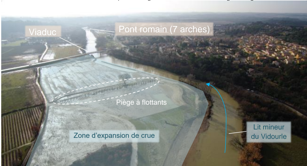
Figure 6 : Vue aérienne du piège à flottants à l'amont de Sommières (source: EPTB Vidourle)
