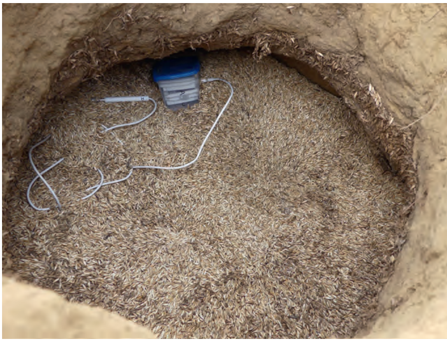
[ill. 4] Chaque silo est muni de trois enregistreurs (Kimo type KH220) protégés dans des boîtes en plastique. Leurs sondes sont placées sur le fond, contre la paroi à mi-hauteur et au cœur du stock. Cette photo montre le désilage du silo S104.16 en 2018, avant le retrait des enregistreurs mis en place en septembre 2017. Les résultats des mesures ont montré
