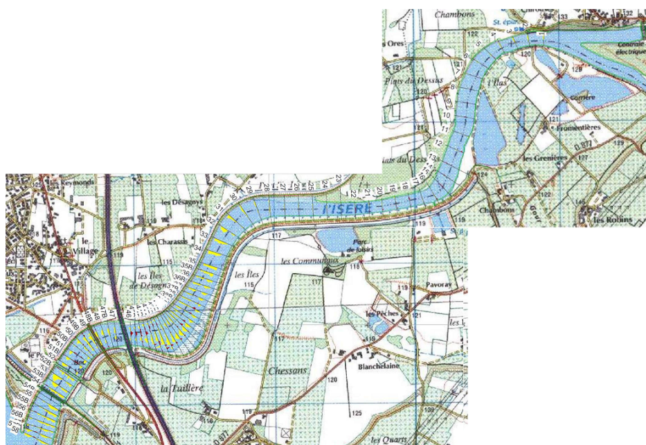
FIGURE 5.1 – Différence (dépôt) entre les bathymétries du 06/01/2021 et du 16/02/2021 sur l'Isère de Beaumont-Montoux à la confluence avec le Rhône.
