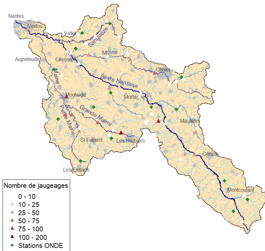
Figure 20 : Répartition des stations de jaugeages ponctuels sur le bassin de la Sèvre Nantaise
