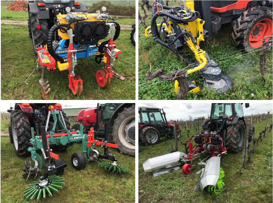
Figure 7.7. Lame bineuse et outils rotatifs avec axe vertical et horizontal (© Macary).
