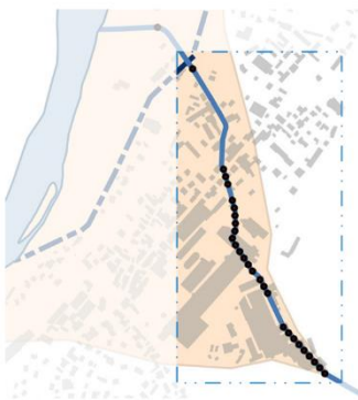
Figure 5 : Synthèse graphique de l'étape c) Tri des sous-scénarios et simplification du problème (en noir les modes de défaillances concernant les singularités et verrous, en rouge ceux concernant les tronçons)
