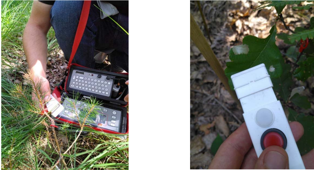
Figure 6: mesure de terrain de la conductance stomatique à l'aide du poromètre. (à gauche) Mesure d'une aiguille appartenant à la pousse annuelle 2021 délimitée par les deux bagues rouges. (à droite) Mesure sur une feuille repérée par une marque rouge sur le pétiole.
