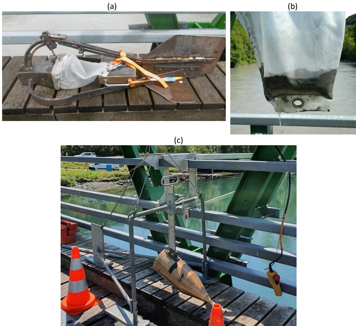
Figure 2 : Instrumentation utilisée au pont de Pyrimont lors de l'APAVER 2021 avec (a) le préleveur Helley-Smith lesté, (b) un exemple d'échantillon collecté avec le Helley-Smith et (c) la bouteille de Delft sur son support
