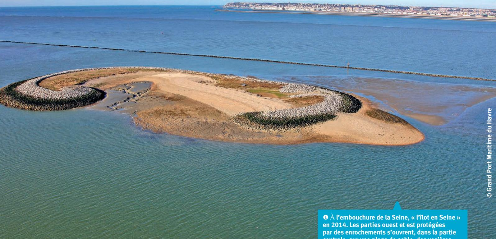
➊ À l'embouchure de la Seine, « l'îlot en Seine » en 2014. Les parties ouest et est protégées par des enrochements s'ouvrant, dans la partie centrale, sur une plage de sable, des vasières et un lagon qui se remplit puis se vide au gré des marées.
