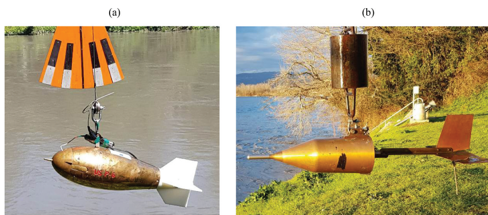
Figure 1. Préleveurs isocinétiques : (a) US-P-06 sur l'Isère à Grenoble campus en juin 2021 ; et (b) Bouteille de Delft déployée en janvier 2021 sur l'Isère à Beaumont-Montoux (France).
