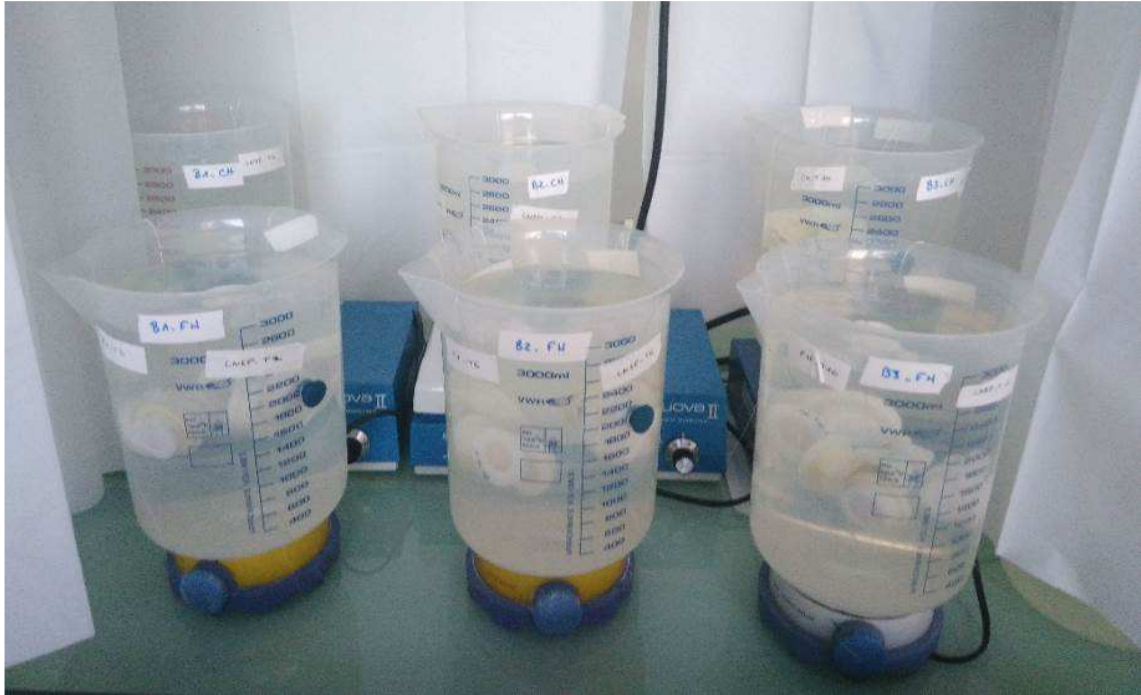
Figure 3 : Photographie du déploiement des DGT dans les solutions de calibration pour la détermination des rendements d'extraction.
