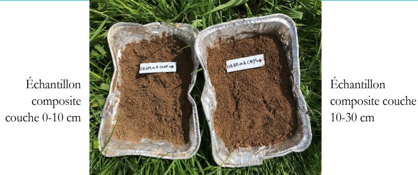
Figure 9 : Photos du prélèvement des échantillons Composites à la tarière Edelman
