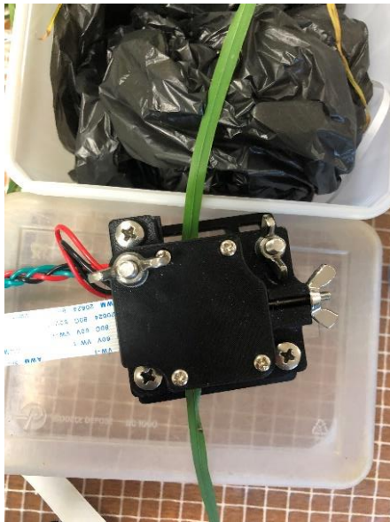
Figure 8. Feuille de dactyle placé dans une caméra CaviCam. Source : L. Custodio.
