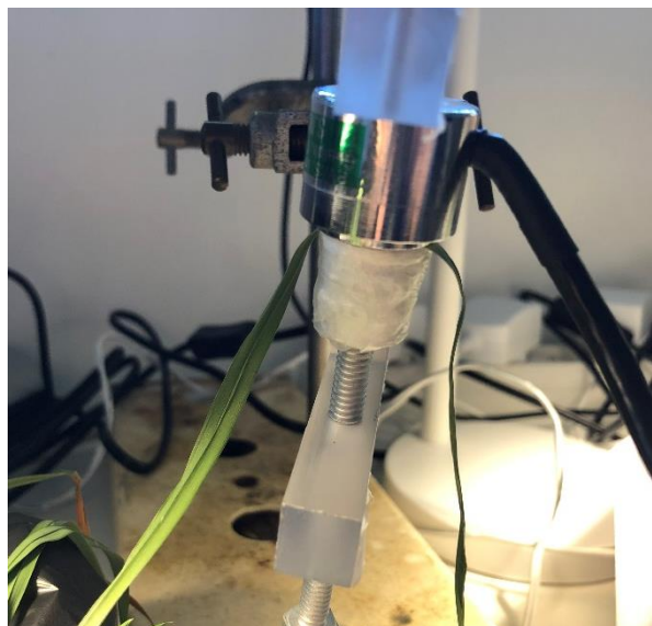
Figure 14. Feuille de dactyle inséré dans le psychromètre. Source : L. Custodio.
