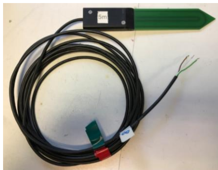
Figure 10 : Sonde SMT100 Truebner
