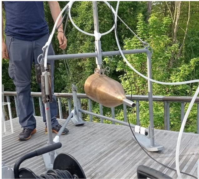
FIGURE 5 – Photographie de la bouteille de Delft avant mise à l'eau
