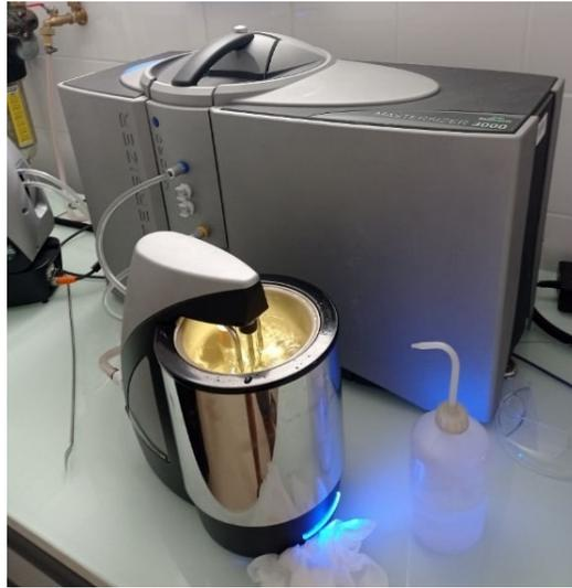
FIGURE 13 – Photographie d'un granulomètre-laser
