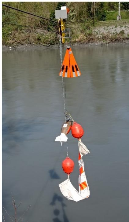
FIGURE 8 – Photographie du préleveur US-P6 lors d’un prélèvement d’échantillon
