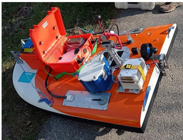
FIGURE 10 – Photographie d'un ADCP avant sa mise à l'eau
