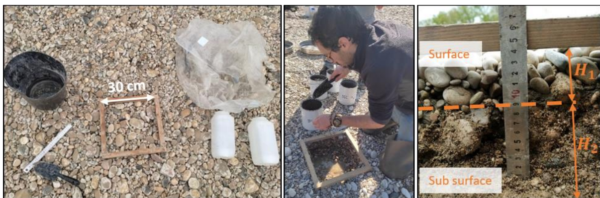
Figure 10: Prélèvement d’échantillons de surface et sub-surface selon la méthode « des placettes » (Deng et al., 2022).
