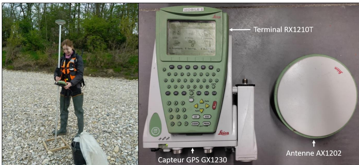
Figure 11 : Acquisition de données GPS à l'aide d'un capteur GPS GX1230 – Leica Geosystems, 2004.
