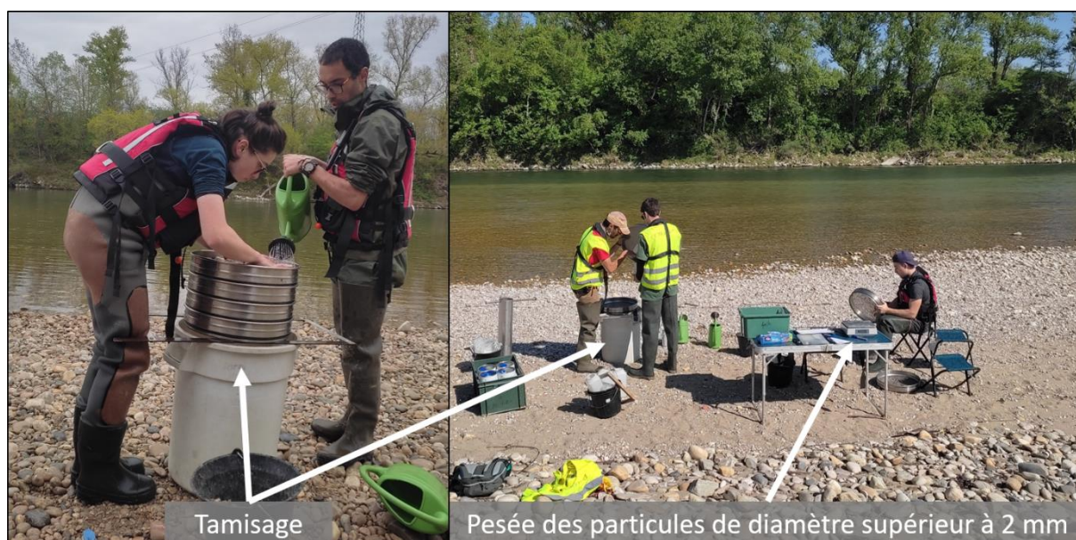
Figure 13 : Dispositifs pour l'analyse de la granulométrie des échantillons : tamisage à 10\text{mm} , 2\text{mm} , 500\mu\text{m} et 10\mu\text{m} ; pesée des particules de diamètre supérieur à 2\text{mm} .
