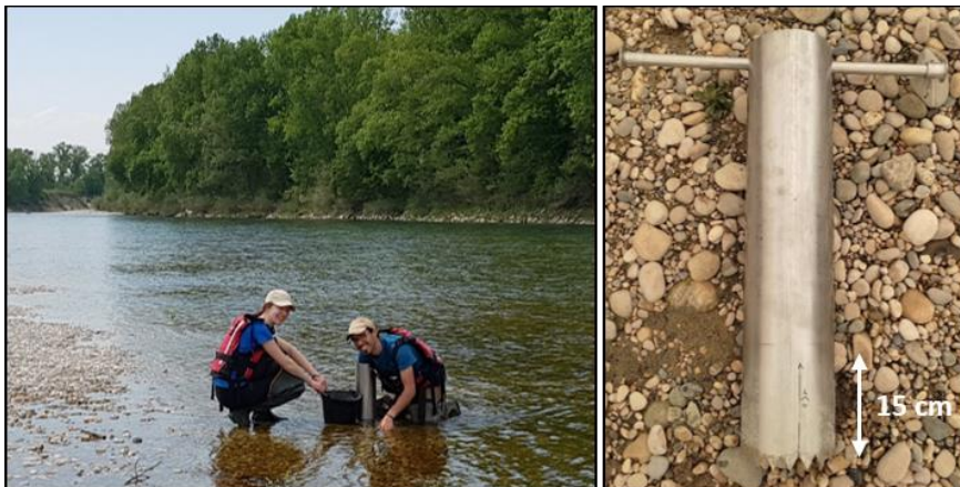
Figure 9: Utilisation en eau et présentation du cylindre de prélèvement (McNeil & Ahnell, 1964).
