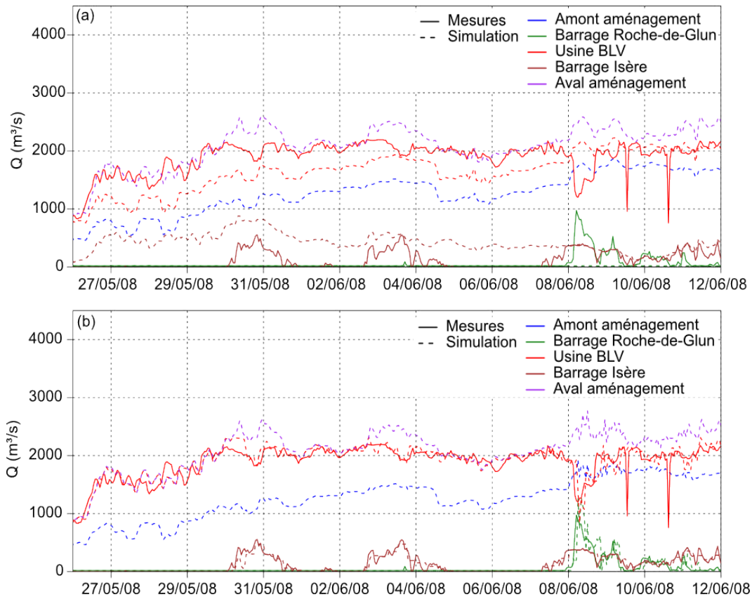
Figure 89: Comparaison des résultats des consignes (a) « automatiques » et (b) « temporelles ». Impact sur la répartition des débits dans l'aménagement de Bourg-lès-Valence pendant l'événement de mai-juin 2008.
