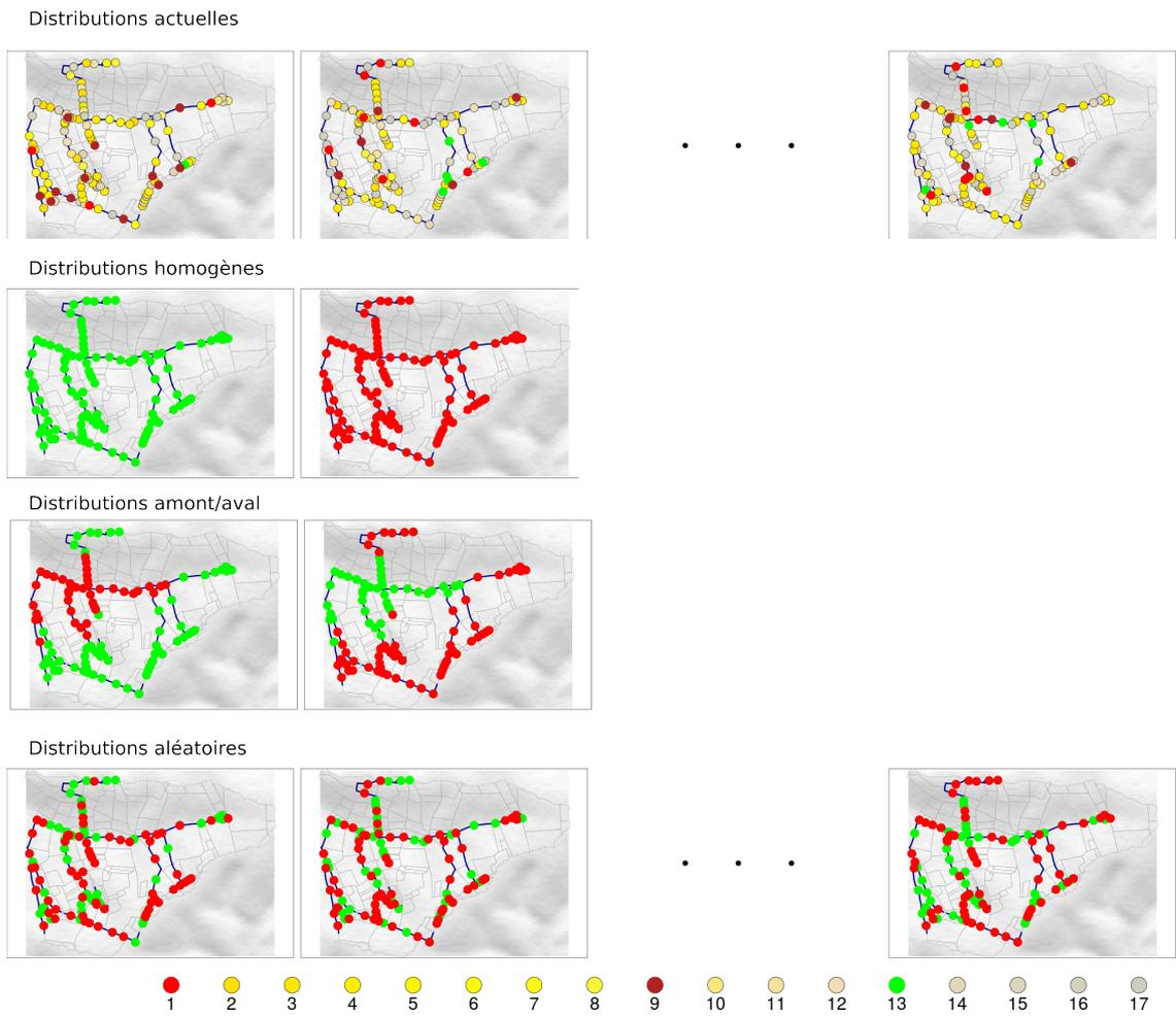
FIGURE 4.9 – Plan d'expériences à l'échelle du réseau - Exemple du bassin du Ruiné amont (Surface d'environ  $1 \text{ km}^2$ ) et de types " fortement hydrophobes". Les couleurs et numéros des points correspondent aux différents types dans la typologie fortement hydrophobe.
