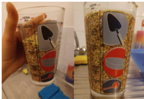
FIGURE 10 – Manipulation de détermination de la porosité
