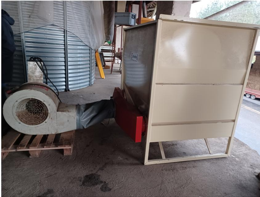
FIGURE 2 – Illustration du dispositif de séchage pré-existant
