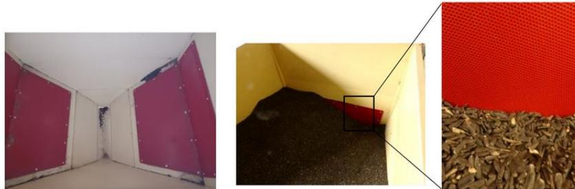
FIGURE 9 – Plaque perforée présente dans le caisson
