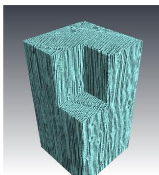
2. **Scanner** ces échantillons en haute résolution par microtomographie à rayons X. Pour cela, le synchrotron SOLEIL, partenaire de ce projet, fournit 48H de temps de faisceau à une équipe du GDR qui pourra alors utiliser le dispositif de microtomographie à rayons X de la ligne PISCHE pour acquérir des images volumiques de structures cellulaires à différentes échelles d'observation.
