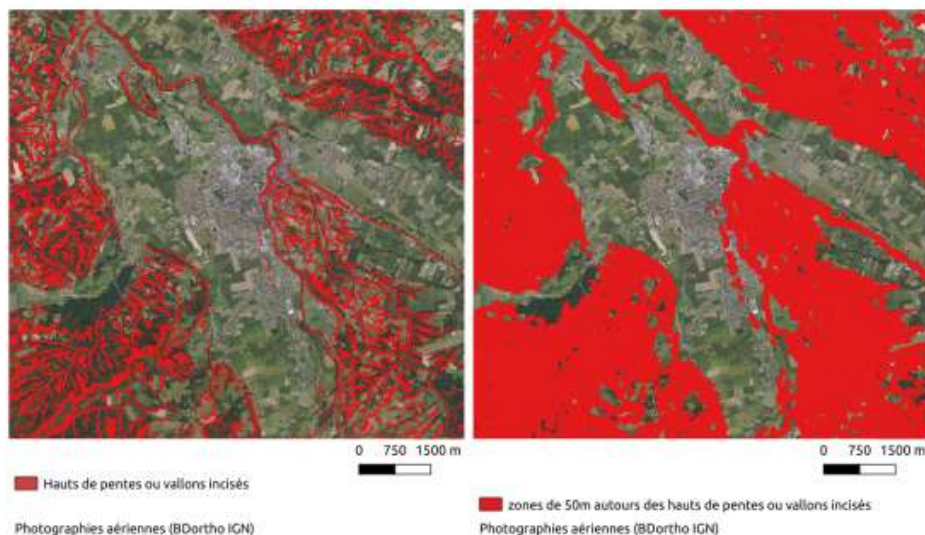
Figure 15 : Ruptures de pente extraite à l'aide du TPI et zone tampon de 50 mètres autour des ruptures de pente formant la zone de vulnérabilité induite par ces dernières. Les couches sont superposées à la BD ORTHO.
