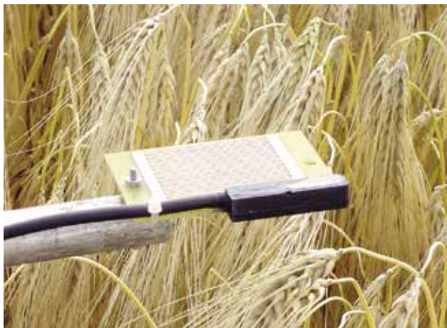
Capteur de flux sur un couvert de céréales, Versailles-Grignon.
