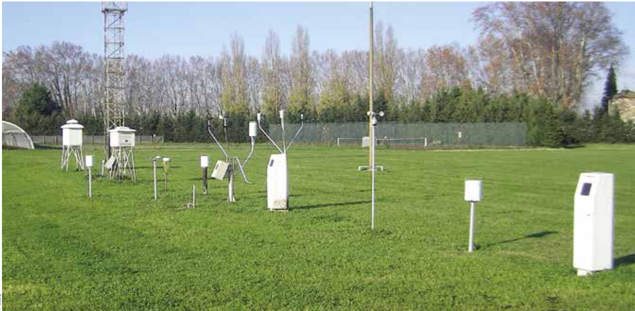
Station météorologique automatisée du réseau agroclimatique Inra, site d'Avignon, 2006.
