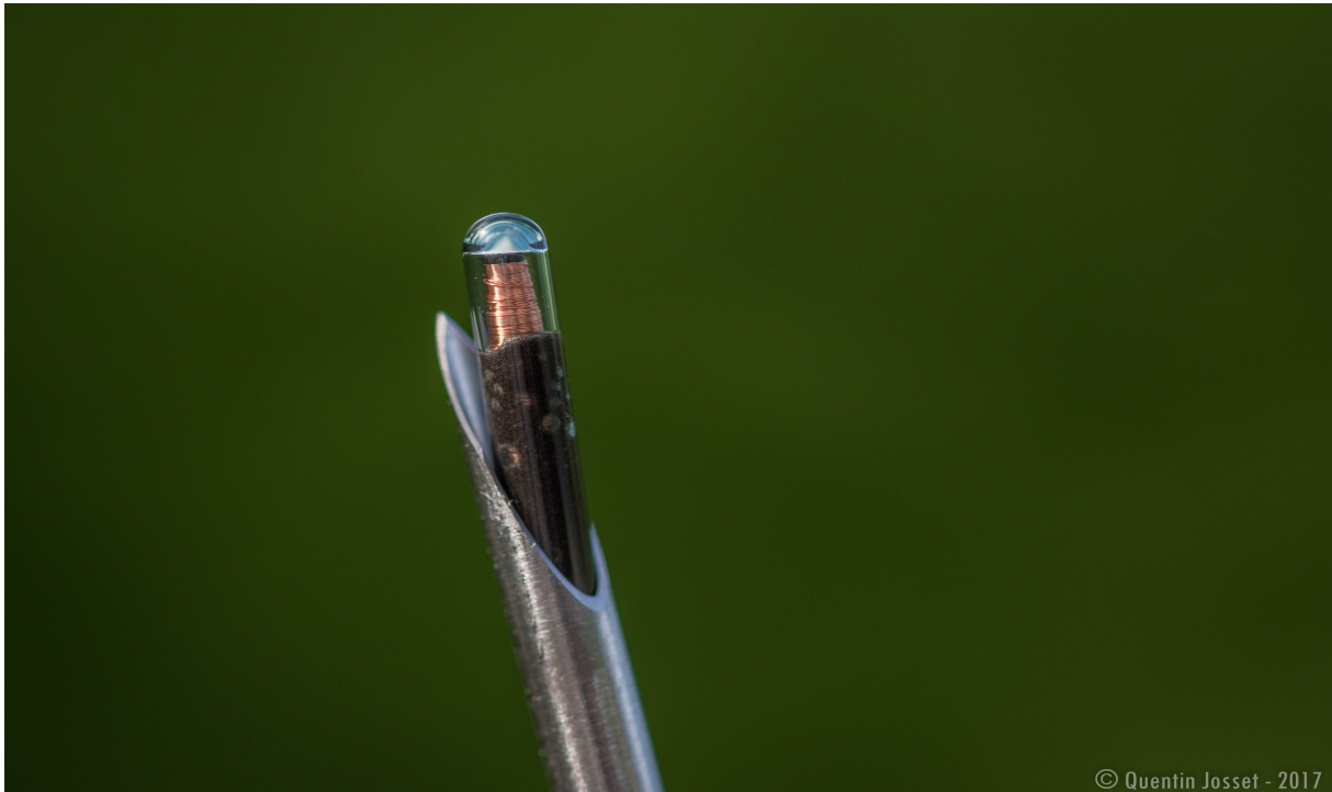
Figure V.3. Marque individuelle passive de type PIT-tag (12 mm).
