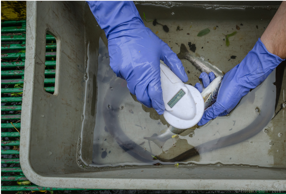
Figure V.5. Lecture d'une marque PIT-tag sur un individu recapturé
