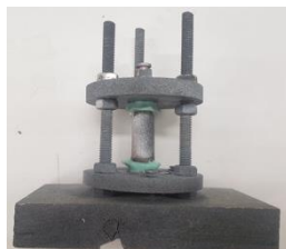
Fig. 2 : Dispositif de mesure du module tangentiel de l'écorce
