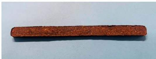
Fig. 2 : Epreuve pour la flexion 3 points
