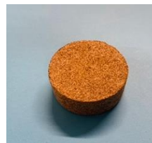
Fig. 3 : Epreuve pour la mesure des caractéristiques physiques et la dureté
