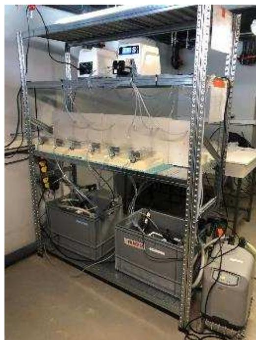
**Figure 29** : Incubateurs (gauche) et dispositif d'exposition utilisé (droite). A l'étage du bas la thermorégulation de l'eau en provenance des incubateurs et son retour vers les pompes péristaltiques, au milieu les incubateurs et en haut les pompes permettant la circulation vers les incubateurs
