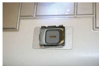
Photo 31 : fixation de la microcarotte au fond du moule par refroidissement de la paraffine
