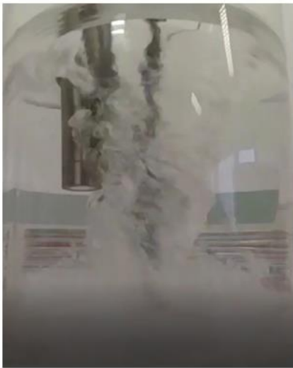
Figure 56 : Effet du déflecteur : (a) Vortex créé par la rotation de l'hélice sans le déflecteur et (b) écoulement dans la chambre de l'EROMES avec le déflecteur pour une tension d'alimentation de 10 V.
