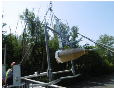
Figure 62 : Photos de la pompe péristaltique lors de la manip sur l'Arc pendant la chasse du 18 juin 2019 (a) et du système de pompe de forage (adapté sur la bouteille de Delft) lors de la manipe sur l'Isère à Grenoble le 4 juillet 2019 (b) (photos Thollet et Camenen).
