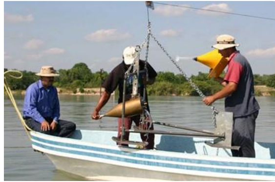
Figure 61 : Préleveurs iso-cinétiques : (a) US-P6 (photo FISP) , (b) bouteille de Delft (photo Royal-Eijkelpamp).
