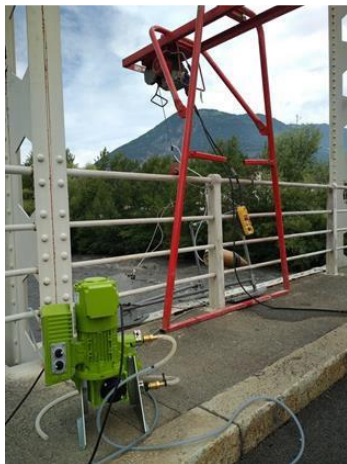
Figure 62 : Photos de la pompe péristaltique lors de la manip sur l'Arc pendant la chasse du 18 juin 2019 (a) et du système de pompe de forage (adapté sur la bouteille de Delft) lors de la manipe sur l'Isère à Grenoble le 4 juillet 2019 (b) (photos Thollet et Camenen).
