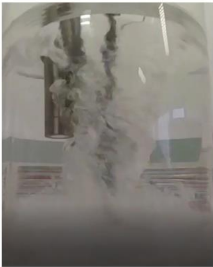
Figure 56 : Effet du déflecteur : (a) Vortex créé par la rotation de l'hélice sans le déflecteur et (b) écoulement dans la chambre de l'EROMES avec le déflecteur pour une tension d'alimentation de 10 V.
