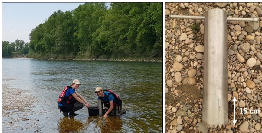
Figure 45: Utilisation en eau et présentation du cylindre de prélèvement (McNeil & Ahnell, 1964).
