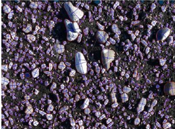
Figure 64 : Exemple d'analyse d'image locale avec le logiciel Basegrain (a) et courbe granulométrique issues de la méthode Wolman (b)
