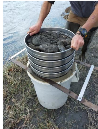
Figure 44: Photographie présentant le protocole de mesure : (a) création d'une placette, (b) tamisage d'un échantillon au dessus d'un bac
