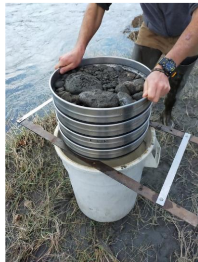
Figure 44: Photographie présentant le protocole de mesure : (a) création d'une placette, (b) tamisage d'un échantillon au dessus d'un bac
