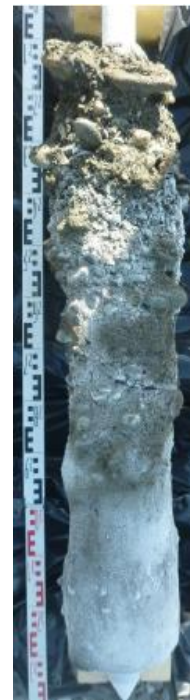
Figure 10 : Illustration d'une carotte prélevée sur le banc dit de « Fréterive » sur l'Isère en combe et composition granulométrique moyenne de l'ensemble des carottes (photos BURGEAP-EDF)
