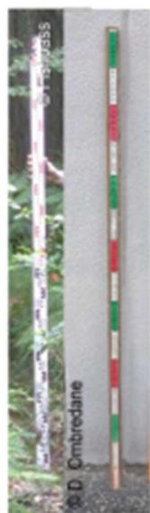
Mire télescopique (à droite) et toise (à gauche)
