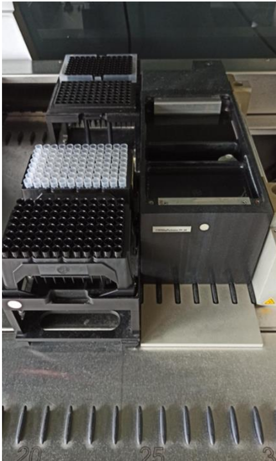
Figure 4 : Photographie du dispositif de lavage des cônes de pipette dans l'unité BFP
