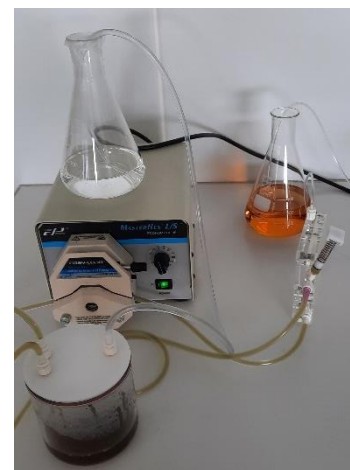
Figure 12 : Appareil d'ultrafiltration utilisé pour fractionner les saponines
