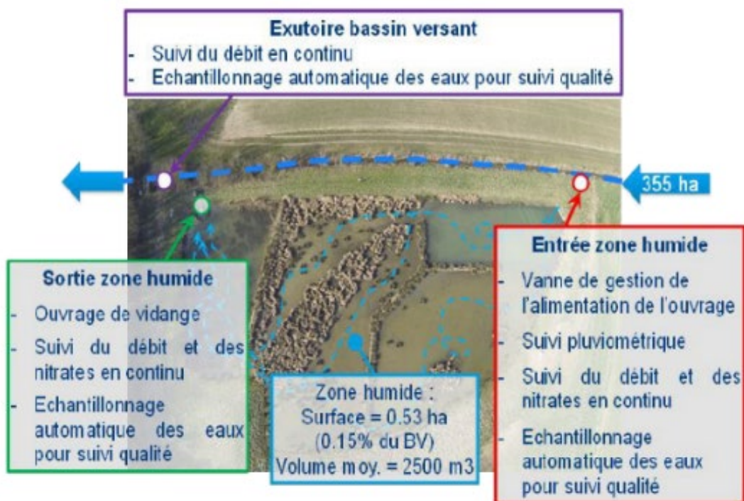
Figure 2 : Fonctionnement de la ZTHA (Cédric CHAUMONT, Julien TOURNEBIZE).
